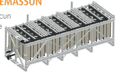
Chaque module est équipé de 60 cylindres capteurs Lemasson fabriqués à 100% en matériaux résistants aux milieux agressifs et permettant, pour chacun, de récupérer 2kW  $\Delta T 3^{\circ}\text{C}$  dans un milieu à  $3^{\circ}\text{C}$ .
